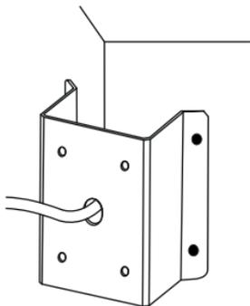
4. Закрепите кронштейн для крепления на стену на установленном основании (см. Паспорт изделия кронштейна для крепления на стену).
