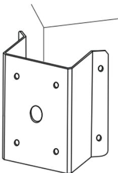
2. Закрепите основание на поверхности анкерными болтами, которые входят в комплект поставки.
