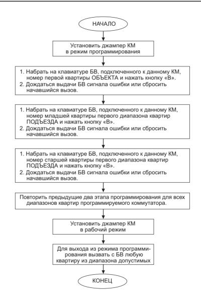
Рис.6 Алгоритм программирования диапазона квартир коммутатора
