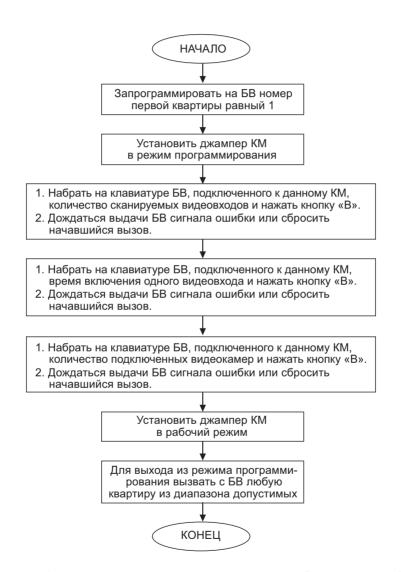
Рис.5 Алгоритм программирования управления видеокоммутацией
