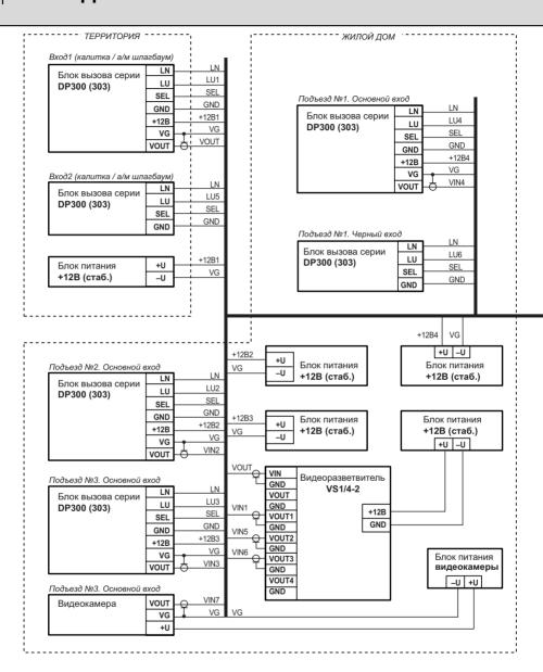
Рис.3 Схема подключения КМ300-4.2 к домофонному комплексу
