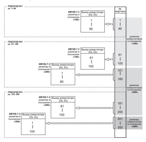
**Рис.4** Пример схемы подключения подъездных коммутаторов КМ100-7.3
